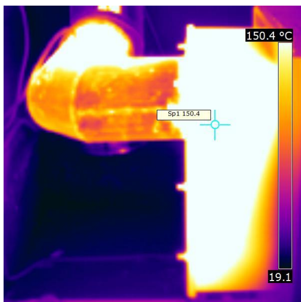
Termografía 30. Salida de humos de caldera de calefacción
