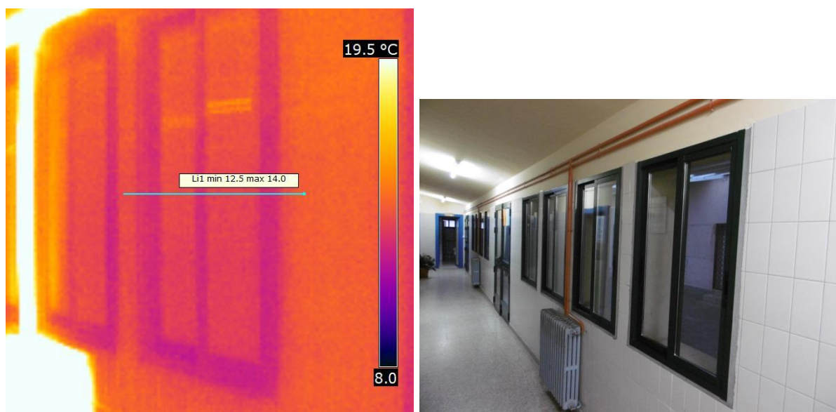
Termografía 26. Ventana de pasillo lateral
