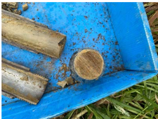
Foto 14: Detalle del Material del Sondeo S-1. SPT-1 (3.00 a 3.60 m).
