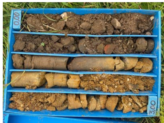
Foto 10: Detalle del Material del Sondeo S-1. Caja C-1 (0.00 a 3.00 m).
