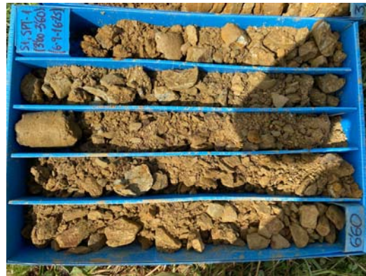
Foto 11: Detalle del Material del Sondeo S-1. Caja C-2 (3.00 a 6.60 m).
