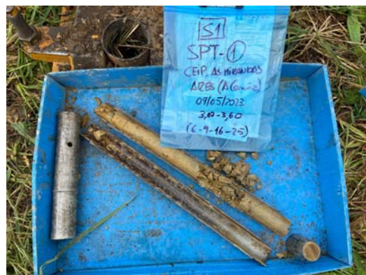
Foto 12: Detalle del Material del Sondeo S-1. SPT-1 (3.00 a 3.60 m).
