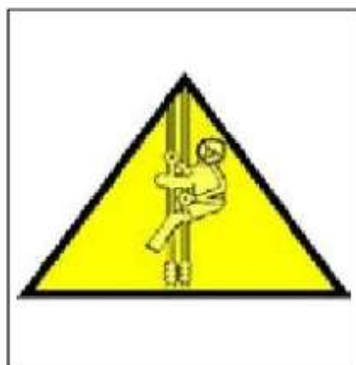
Figura 10. Ejemplo de señal de peligro de realización de trabajos verticales.
