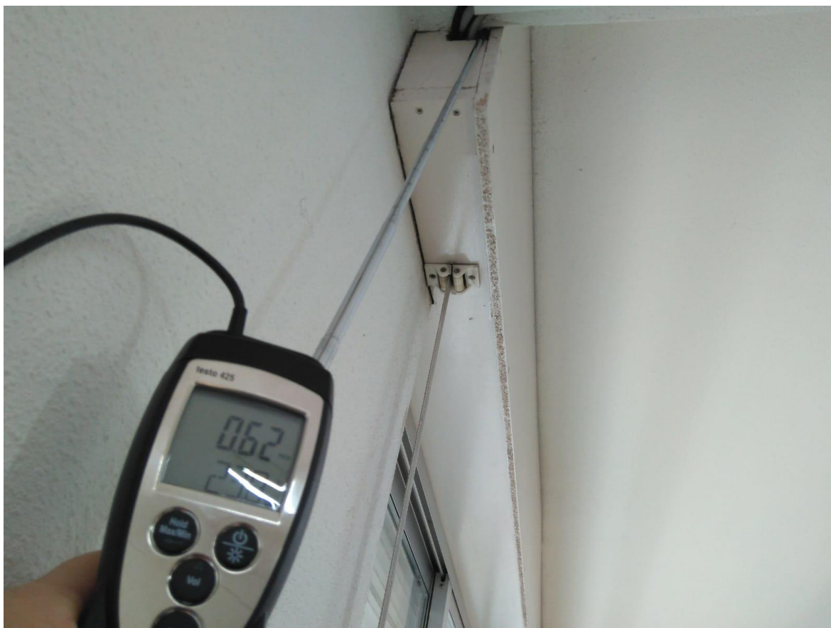
Medición de infiltraciones con el anemómetro en una caja de ventanas.
