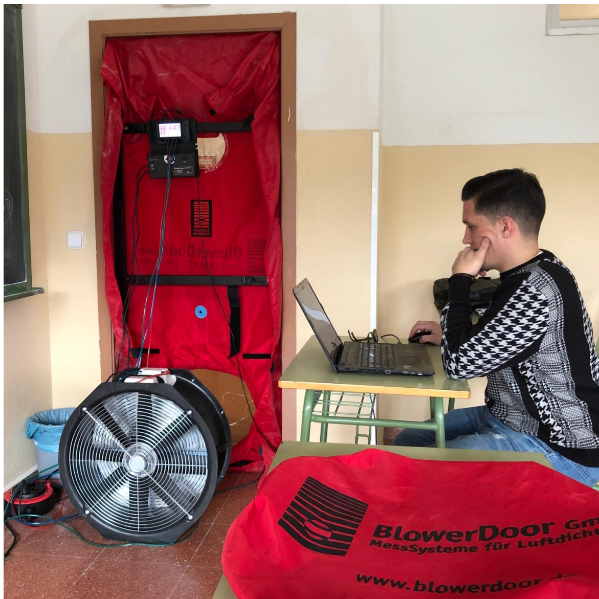
Medición de infiltraciones mediante el test de blower door.
