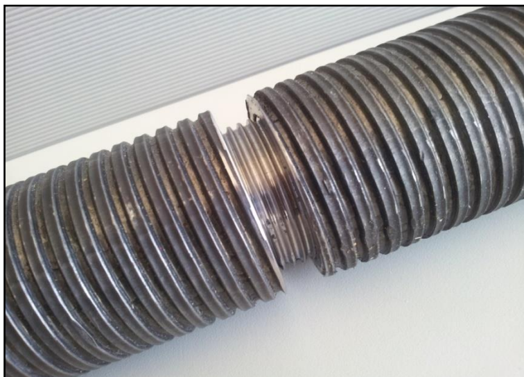
Imagen n.º 3: Detalle exterior del micropilote.
