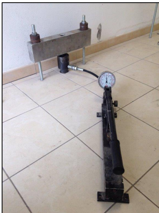
Imágenes n.º 4, 5, 6 y 7: Detalle del dispositivo de precarga fijo y su puesta en obra.
