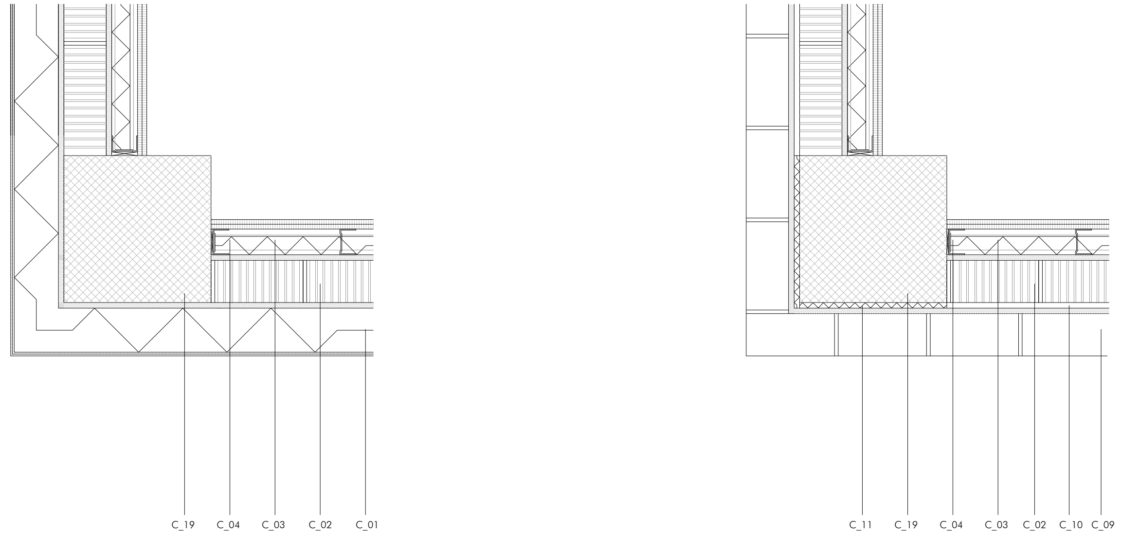
SECCIÓN HORIZONTAL CERRAMIENTO ESQUINA e. 1_10 0 20 40 100
