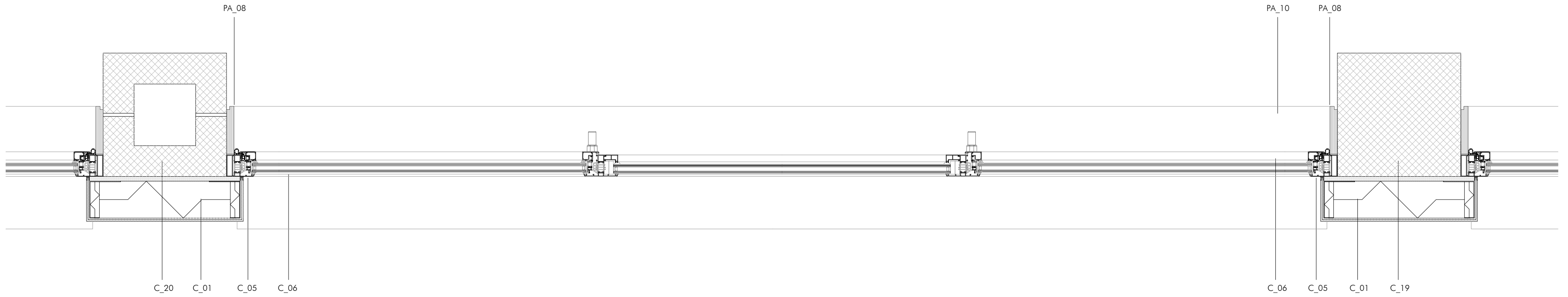
SECCIÓN HORIZONTAL VENTANA TIPO e. 1_10 0 20 40 100
