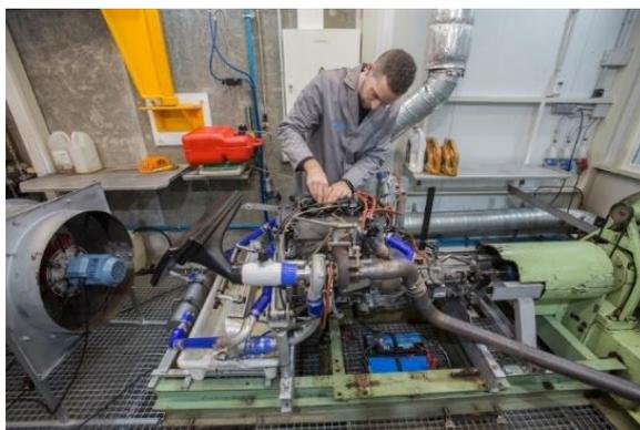
Foto: Celda de ensayo de motores
