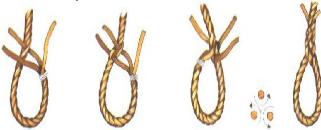
**Costura:** Es la unión de dos cabos o cables por sus extremos.
