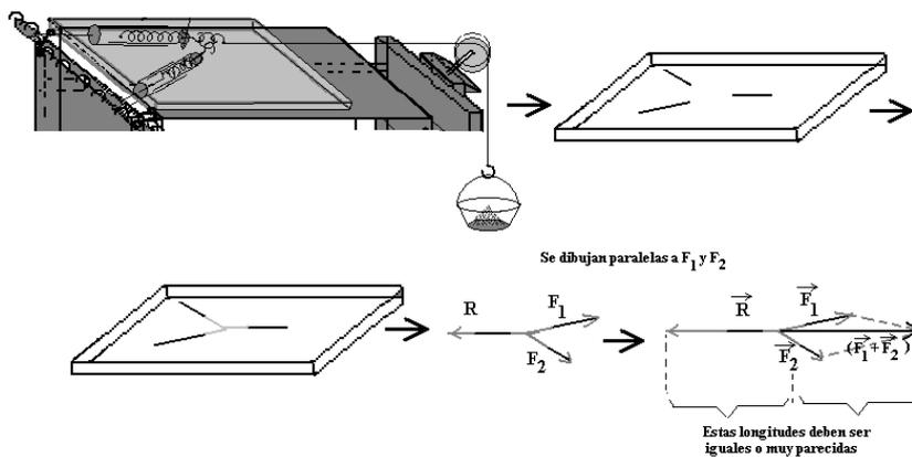
B).- A continuación se colocan los dos dinamómetros superiores sobre otros sujetadores alejados entre si y se vacía el vaso y se va llenando de arena hasta que el ángulo sea de  $90^\circ$  comparando con una escuadra o la esquina de una hoja, se repite y se le hace la prueba mediante el teorema de Pitágoras.
