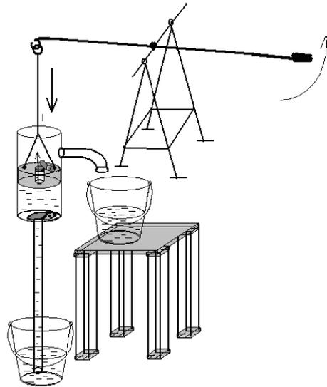
I).- Cuando sube el émbolo se cierra la válvula superior y el agua almacenada puede escapar por el agujero de la tubería superior.
