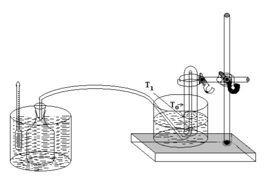
3.- Se puede sustituir el tubo de ensayo invertido por una probeta de tamaño similar, así podremos leer directamente los volúmenes, sin tener que pasar por el necesario paso de establecer una "regla de tres", construida midiendo el volumen de agua que el tubo de ensayo pueda contener como máximo y el asociado la altura de este.
