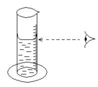
B).- Se introduce una cierta cantidad de agua en la probeta (la mitad aproximadamente, por ejemplo). Se anota el volumen hallado.
