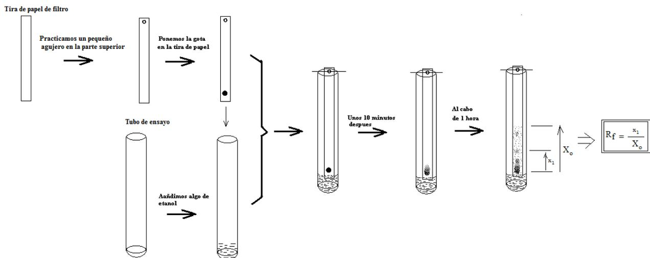
7.- Se espera unos 5 minutos y se observa que el ascenso del alcohol y este empieza a arrastrar de distinta manera los componentes de la gota que está sobre la marca.
