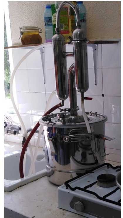
Figura 1: Destilador para obtención de hidrolatos. Foto Miguel Freire
