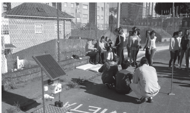
Actividade interdisciplinar Matemáticas - Tecnoloxía sobre enerxía solar (2014-2015). Comprobación da produción a distintas horas e con distintos ángulos de calaxe do panel fotovoltaico.
