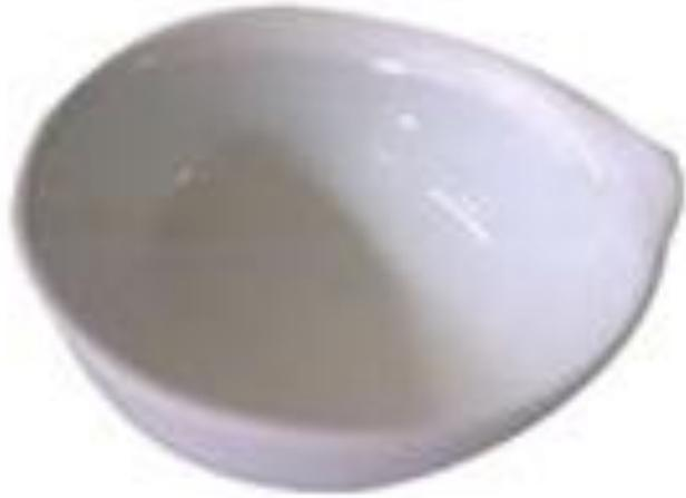
Material de laboratorio de porcelana, que se utiliza para la separación de mezclas, por evaporación y para someter al calor ciertas sustancias que requieren de elevadas temperaturas.
