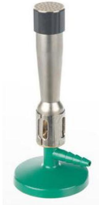
Es un instrumento de vidrio o metal, destinado a proporcionar combustión. Los más usados son los de alcohol y los de gas, principalmente, el de Bunsen.
