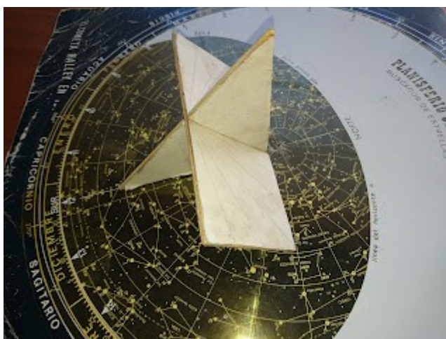
Foto: maqueta dun cuadrante ecuatorial feito por min, con regra e compás, realizado en chapa e cortado cun cúter hai máis 30 anos
