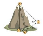
Para poder calcular la altura  $\overline{AB}$  en el triángulo BAC necesitamos  $\overline{BC}$ , que lo podemos obtener aplicando el teorema del seno en el triángulo BCD:
