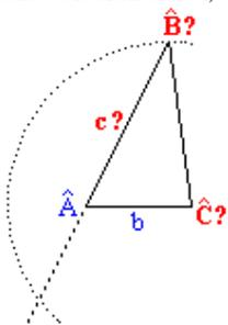
El triángulo se resuelve por el teorema del seno
