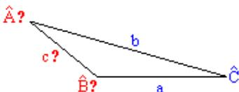
El lado que se desconoce se calcula mediante el teorema del coseno
