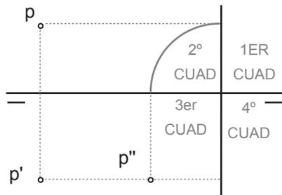
Como se observa a la izquierda el arco, que representa el abatimiento del plano de perfil, en este caso se encuentra sobre la línea de tierra y a la izquierda del plano de perfil. Esto se debe a que el abatimiento siempre afecta al alejamiento y no a la cota, que permanece al ser el abatimiento del plano de perfil sobre el plano vertical de proyección.
