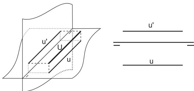
A la izquierda se puede observar una recta paralela a la línea de tierra la cual no tiene trazas.
