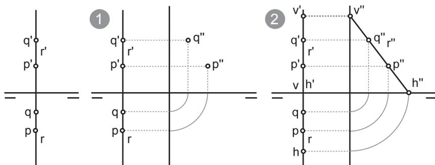
1º- Trazamos el plano de perfil auxiliar, proyectamos los dos puntos en él y lo abatimos sobre el vertical, de este modo ya observamos las terceras proyecciones de ambos puntos.
