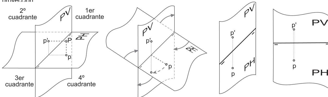
Para poder representar el diedro en dos dimensiones, es decir sobre un plano, el plano horizontal de proyección se abate sobre el vertical, usando como charnela (eje de giro) la línea de tierra, llevando con él todas sus proyecciones de los elementos en el espacio. (ver los cuatro dibujos arriba)
