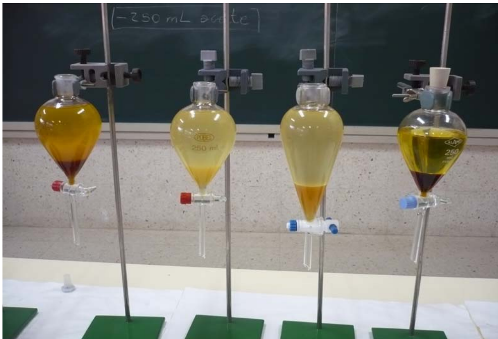
Decantación para separar o biodiésel da glicerina.
