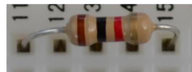
En la resistencia de la imagen tenemos un valor de  $1000 \Omega$ , con una tolerancia de  $\pm 5\%$ , pero ¿cómo podemos saberlo? Para eso necesitamos tener una tabla con la equivalencia entre los colores y los números.
