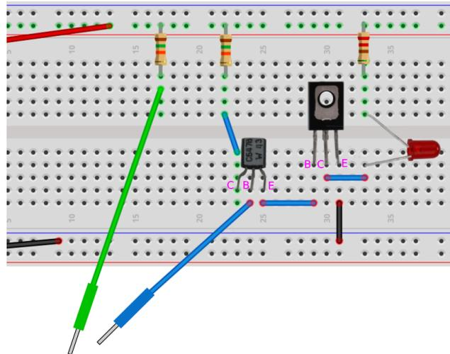
**Importante:** Ten mucho ojo con la conexión del diodo LED, ya que tiene polaridad (un polo positivo y otro negativo), y con los transistores: identifica en cada uno de los modelos usados cual es la base(B), el colector (C) y el emisor(E) y conéctalos correctamente.
