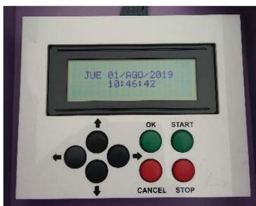
En el cajón superior, protegido por cerradura, se encuentra el panel de operación del sistema. Presionando sobre el pulsador verde indicado como START se inicia el proceso de carga de los equipos portátiles, que durará las 4 horas programadas por defecto. Se puede comprobar que la carga está activa gracias al piloto de color amarillo situado en la parte superior de Educar.
