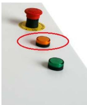
En caso de necesitar parar la carga antes del periodo definido, se hará pulsando el botón rojo ubicado en el panel de control e indicado como STOP. Esta operación detiene el proceso de carga, pudiendo ser reiniciado en cualquier momento mediante la pulsación del botón verde indicado como START.
