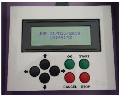
Nuestro sistema Educar puede ser gestionado de modo local mediante el LCD que posee el equipo en la parte superior. Para ello se presenta un menú navegable que puede ser gestionado mediante los botones de flecha.
