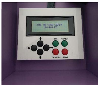
El sistema Educar, está dotado de un programador con display gráfico que permite configurar el periodo de carga de los equipos ubicados en su interior de modo visual y sencillo. El programador posee conexión IP por lo que también es posible realizar la configuración desde un navegador web (Mozilla Firefox).
