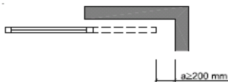
Figura 2.1 Holgura para evitar atrapamientos
