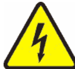
Sinal de advertencia "risco eléctrico"
