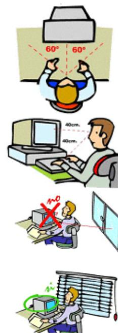
A mellor disposición do teclado é fronte á pantalla de maneira que non sexa necesario realizar xiros constantes da cabeza. Disporase como mínimo diante do teclado de 10 cm. para que o usuario poida apoiar os brazos, os pulsos e as mans. Na colocación do resto do equipo terase en conta o alcance manual.
