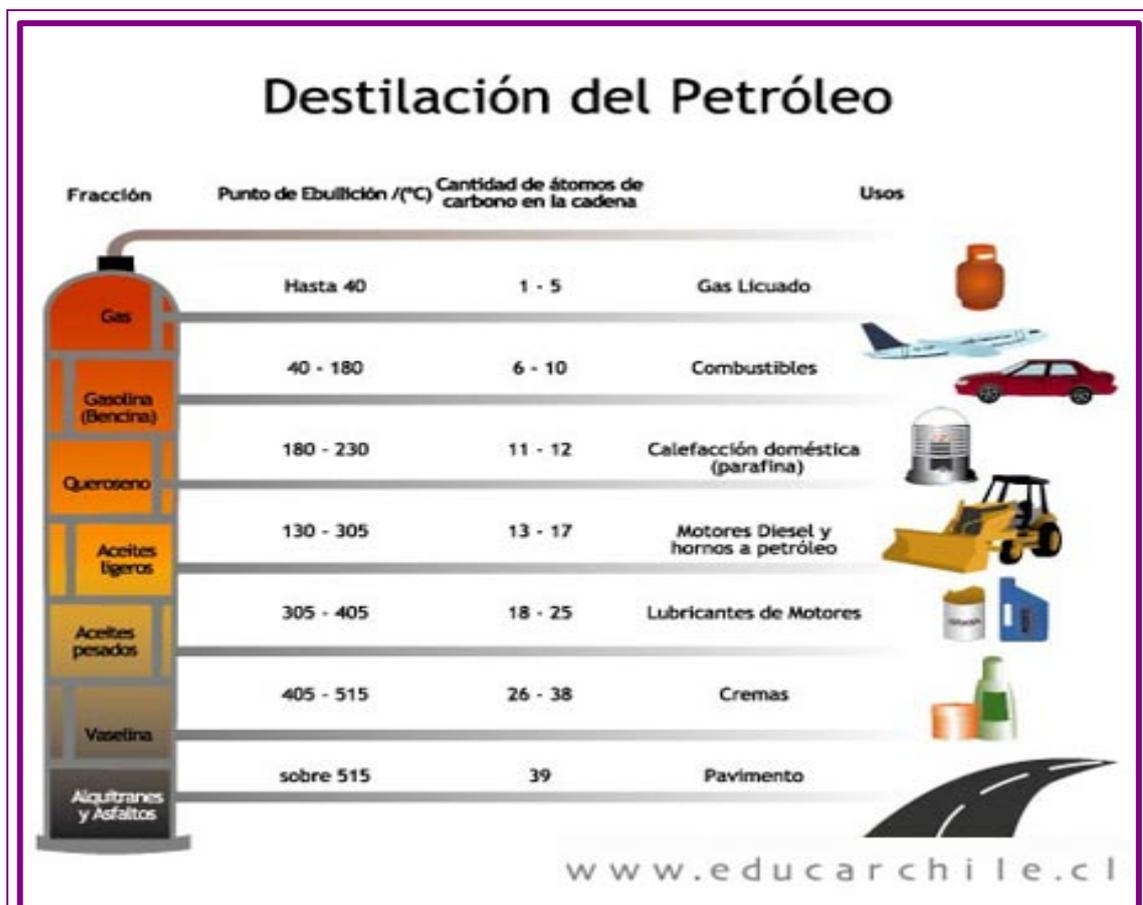
El craqueo del petróleo consiste en una destilación a diferentes temperaturas en las que se van obteniendo diferentes productos.
