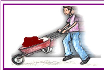
Una carretilla es una palanca del tipo dos. Si aplicamos la ley de la palanca:
