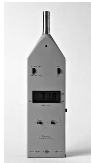
O sonómetro mide o nivel de intensidade sonora.
