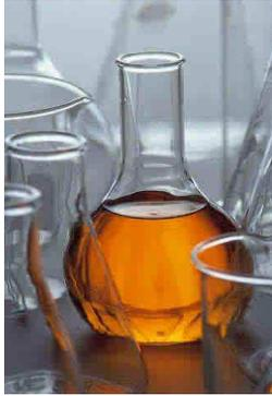
**Matraz.** Instrumento de laboratorio que se utiliza, sobre todo, para contener y medir líquidos. Es un recipiente de vidrio de forma esférica o troncocónica con un cuello cilíndrico.
