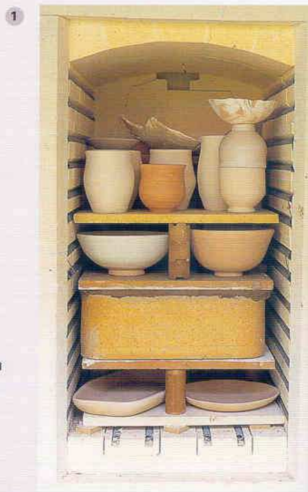
1 CARGA DE UN HORNO PARA EL BIZCOCHADO
