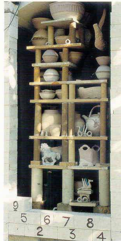
2 CARGA DE UN HORNO PARA LA COCCIÓN DE ESMALTE
