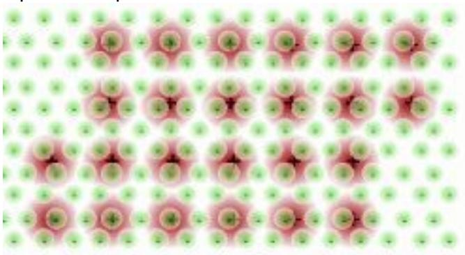
La existencia de la nube electrónica hace que las capas de iones puedan deslizar unas sobre otras sin que la repulsión entre ellas rompa el sólido. Debido a ello los metales son dúctiles y maleables
