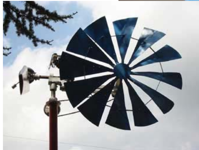
Multipala: bombeo de agua
