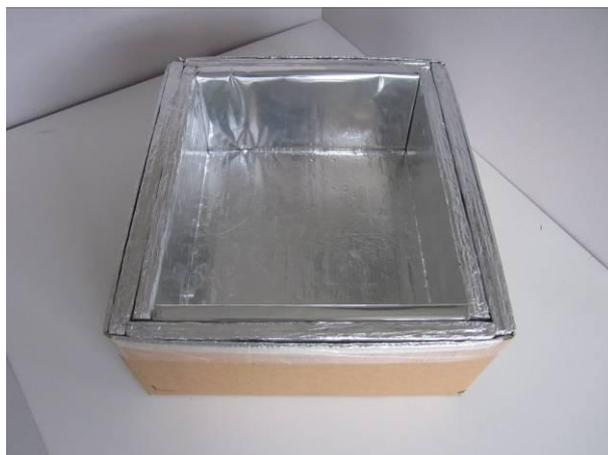
Con la doble capa de aislamiento, intercalándola en las esquinas, se reducen mucho las pérdidas de calor por el suelo y las paredes (funciona de la misma manera tanto para un horno solar como para un edificio)
