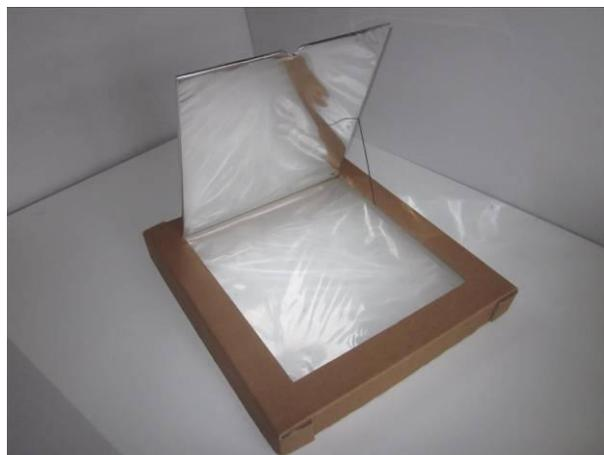
La tapa se completa pegando sobre ella un cristal (con silicona) o una **lámina plástica transparente** (tipo acetato de encuadernación) empleando **cinta adhesiva ancha** (tipo precinto de embalar paquetería).
