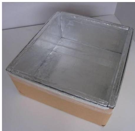
Es necesario repetir el proceso con otra capa de aislamiento del fondo y las cuatro paredes con las medidas correspondientes. El papel de aluminio de cocina es lo más asequible, pero también se puede utilizar plástico aluminizado como el que se emplea para envolver regalos.
