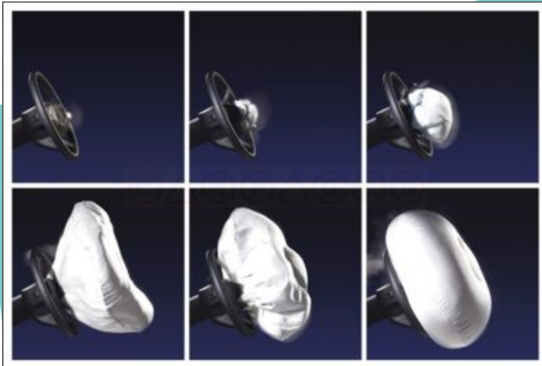
Secuencia fotográfica do inflado do airbag do piloto
