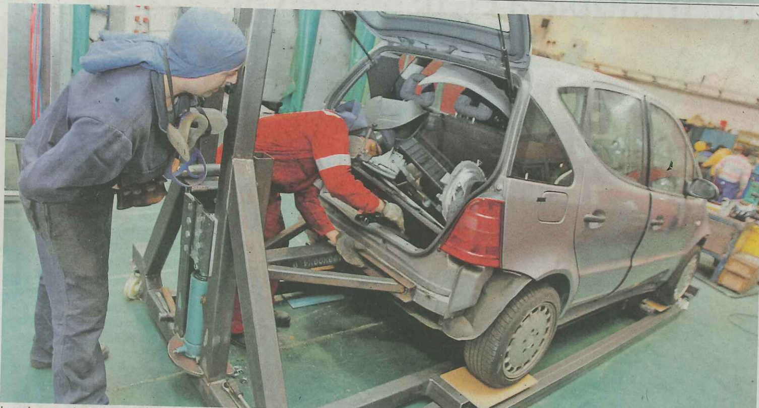
Los alumnos de Fabricación Mecánica construyen un sistema para volcar coches y que los estudiantes de Sanitaria practiquen la exarcelación.
