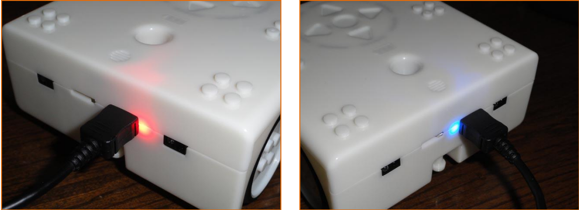
Proceso de carga (izquierda) y carga completada (Derecha)
