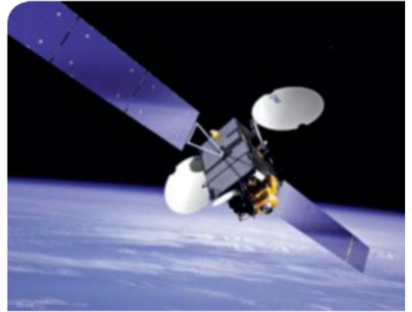
② Satélite artificial Artemis. Este satélite consegue a súa electricidade grazas ás células fotoeléctricas das súas dúas grandes placas solares.
