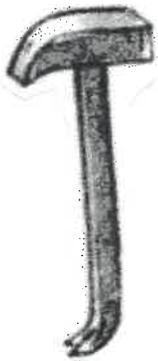
**Martelo:** Ferramenta composta de uma peça de material forte e pesado como o ferro encaixada num mango, que se utiliza para dar golpes com diferentes fins.
