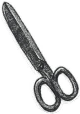
**Tesoiras:** Instrumento para cortar que está constituido por dúas pezas cun só gume, unidas en forma de aspa por un eixe, arredor do cal xiran a o seren accionadas.
