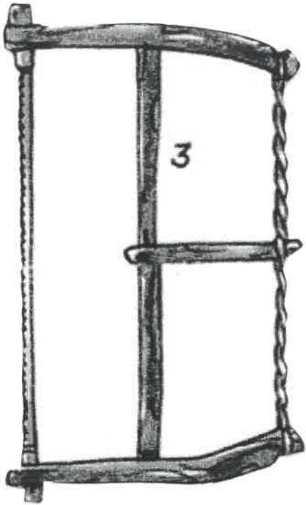
seira de volta: seira que tem unha folla delgada montada sobre un bastidor, que permite o tensado mediante unha pesa de madeira que xira arredor dun cabo retorcido.
