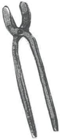
Tenaces: ferramenta formada por 2 braços móveis de metal unidos por un eixe e rematados en forma de gancho, que se utiliza para agarrar, cortar ou arrincar algo.
