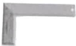
Escuadro: instrumento, sceral-mente de metal ou madeira, con forma de triángulo rectangular
