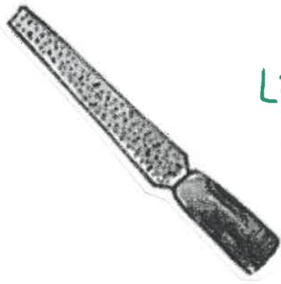
**Lima:** Barra de aço com a superfície estriada que serve para desgastar e alisar materiais duros.
