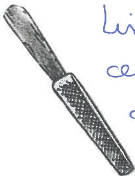
lima: barra de metal ou de aço com superficie estriada que serve para desgastar e alisar materiais duros.
