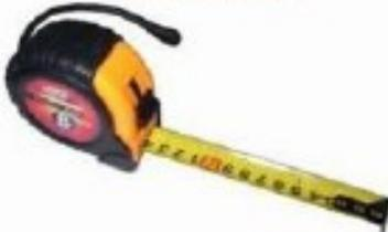
Es metálica, se adapta a formas curvas y se guarda enrollándose fácilmente.
